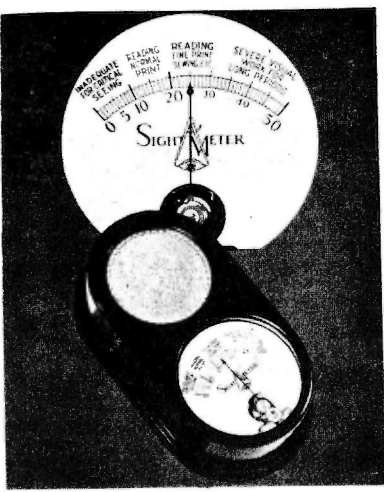
El "iluminómetro", ingenioso aparato que mide la intensidad de luz.
